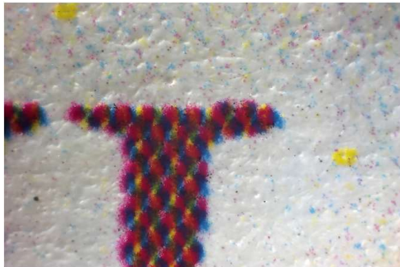
印刷物上のトナーの斑点 (広視野モデルにて撮影)
