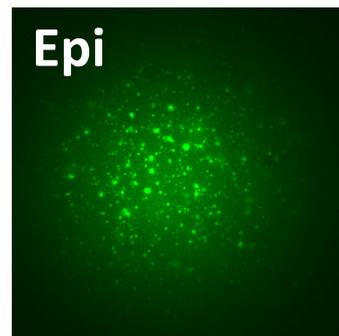
FITC溶液中のFITC蛍光ビーズ（粒径120nm）をTIRF照明、HILO照明、Epiにて取得した画像
