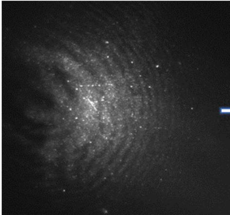
従来のTIRF照明では、干渉縞による照明強度ムラが原因で蛍光強度にムラが生じる場合があります。
